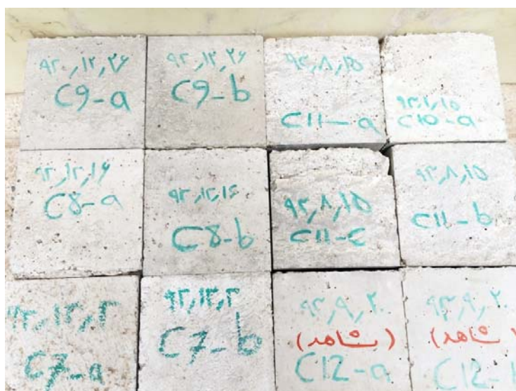
شکل شماره ۵- تصویری از نمونه های بتن ساخته و رواداری شده این پژوهش به همراه تاریخ ساخت
