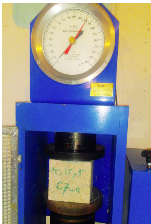
شکل شماره ۶- نمونه های در حال آزمایش - در اینجا عدد ۱۲۵ تن نمونه C7-a خوانده می شود
