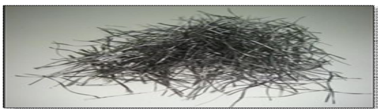
شکل (۱): انواع مختلف الیاف مصرفی، الف) الیاف فولادی ب) الیاف پلی فنیلین سولفاید ((PPS))
