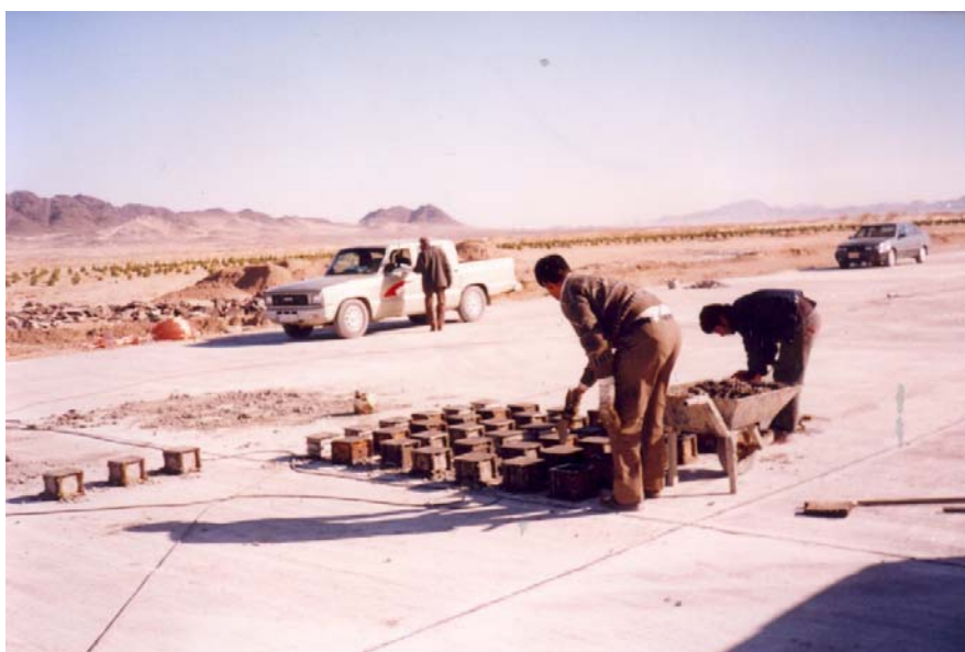
شکل ۲- نمونه برداری مکعبی از بتن تازه به بعد ۱۵۰ میلیمتر مطابق استاندارد ایران در سال ۸۵
